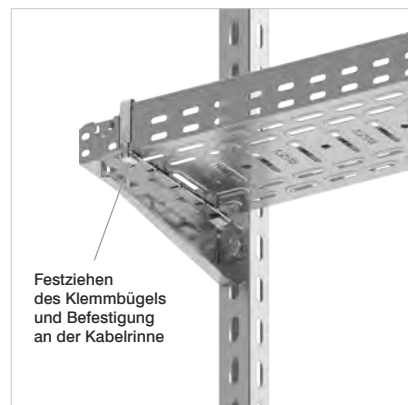
3. Einführen eines zweiten Klemmbügels in den Auslegerschlitze und Befestigen an der Kabelrinne
